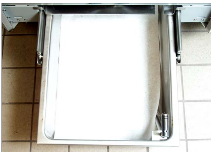
Lägg ett ark filterpapper eller ett filterblock över skärmen. Om du använder blocket, säkerställ att den ojämna sidan av blocket är vänd uppåt.
